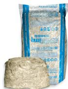
Lose Wolle LW ist lose Steinwolle ohne Bindemittel, nichtbrennbar, schall- und wärmedämmend, alterungsbeständig, wasserabweisend. Für jede Art von Stopfdämmung, z.B. in schwer zugänglichen Hohlräumen im Anlagen- und Industriebau, geeignet; für den Hochtemperaturbereich bis ca. 800 °C (abhängig von der Stopfdichte).
