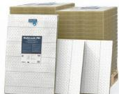
Multimastic FB1 und Multimastic FB2 sind Brandschutzplatten mit einem Kern aus Steinwolle mit einer hohen Dichte, auf einer oder auf beiden Seiten mit der Brandschutzbeschichtung Multimastic C behandelt. Mit den Brandschutzplatten Multimastic FB lassen sich grössere Öffnungen für eine feuerfeste und rauchdichte Ausführung zu angrenzenden Bereichen abdichten.
