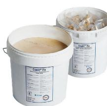
Conlit® Fix ist ein nichtbrennbarer Klebstoff, der speziell für die Stoßverbindungen der Conlit® Ductrock-Produkte entwickelt worden ist. Er besteht im Wesentlichen aus Wasserglas und anorganischen Füllstoffen. Verarbeitbar ab +5 °C. Unter +5 °C bis -7 °C ist der Conlit® Fix Cold zu verwenden. Unter normalen Bedingungen kann von einer Abbindezeit von ca. 12 Stunden ausgegangen werden. Verbrauch ca. 70 g/m<sup>2</sup>.
