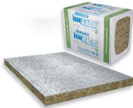
Das Knauf Insulation BD 912 ALU (HBD F12 ALUR) Fire-teK System dient dem vorbeugenden Brandschutz an Lüftungskanälen. Es kommen Mineralwolle-Platten zum Einsatz, die einseitig mit einer reissfesten, glasgitterverstärkten Aluminium-Folie versehen sind. Das Knauf Insulation Fire-teK System schützt nicht nur im Brandfall, sondern verfügt gleichzeitig über gute Wärme- und Schallschutzeigenschaften. Die maximale Abmessung des Lüftungskanalquerschnittes beträgt 1'250 x 1'000 mm.
