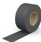
Hensotherm 7KS Gewebe ist ein beschichtetes Gewebe mit einer dämmsschichtbildenden Brandschutzwirkung. Es ist hoch flexibel und kann daher in engen Windungen verarbeitet werden. Die Beschichtung ist frei von Halogenen, APEO, Boraten, Fasern und Weichmachern. Mit ihrer Non-VOC-Eigenschaft entspricht die Beschichtung den Anforderungen des LEED credit EQ c4.2.
