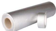
Aluminiumkaschierte Folie mit einem speziellen Klebstoff, der eine erhöhte Klebkraft auch bei niedrigen Temperaturen gewährleistet. Die Struktur besteht aus 7 Lagen, welche Aluminium- und Polyesterfolien umfassen, eine Schicht Polyacryl-Kleber und eine transparente UV-Schutzschicht.
