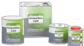
Dieser Kleber dient dazu, die Kautschuk-Produkte von Armacell (außer Solar-HT) und anderer Hersteller miteinander zu verkleben. Der Kleber basiert auf Polychloropren, ist frei von Aromaten und nach der Aushärtezeit von 36 Stunden geruchsneutral. Der Kleber haftet hervorragend auf allen metallischen Untergründen und anderen glatten Oberflächen, jedoch NICHT auf Asphalt-, Bitumen- und Mennige-Anstrichen (Leinölbasis).
