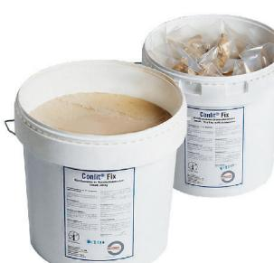
Conlit® Fix ist ein nichtbrennbarer Klebstoff, der speziell für die Stoßverbindungen der Conlit® Ductrock-Produkte entwickelt worden ist. Er besteht im Wesentlichen aus Wasserglas und anorganischen Füllstoffen. Verarbeitbar ab +5 °C. Unter +5 °C bis -7 °C ist der Conlit® Fix Cold zu verwenden. Unter normalen Bedingungen kann von einer Abbindezeit von ca. 12 Stunden ausgegangen werden. Verbrauch ca. 70 g/m<sup>2</sup>.
