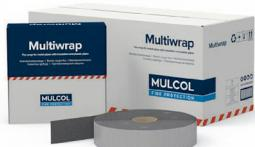
Die Multiwrap ist ein selbstklebendes Band auf einer Rolle auf Graphitbasis, für die Brandabschottung von brennbaren Rohren und Isolierungen. Die Multiwrap sorgt für eine Brandabschottung zu benachbarten Räumen. Die Multiwrap reagiert bei Hitze und verschließt Öffnungen, die durch das Schmelzen von Kunststoffrohren oder brennbarer Isolierung entstehen.
