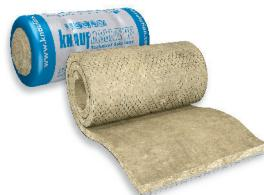
Drahtnetzmatte mit ca. 80 kg/m<sup>3</sup> sind mit verzinktem Draht auf Drahtnetz (20 mm x 0.7 mm) gesteppte Steinwollmatten für Industrie und Schiffbau.
