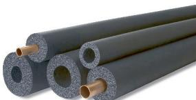
Flexibler Elastomerschaum mit verbesserten flammhemmenden Eigenschaften, geringer Rauchentwicklung, geschlossenzelliger Struktur und eingebautem antimikrobiellem Microban® Schutz. Für Anwendungen in der Kälte- und Klimatechnik sowie für verfahrenstechnische Anlagen in der Industrie.
