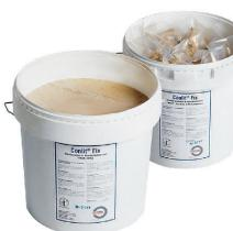
Conlit® Fix ist ein nichtbrennbarer Klebstoff, der speziell für die Stoßverbindungen der Conlit® Ductrock-Produkte entwickelt worden ist. Er besteht im Wesentlichen aus Wasserglas und anorganischen Füllstoffen. Verarbeitbar ab +5 °C. Unter +5 °C bis -7 °C ist der Conlit® Fix Cold zu verwenden. Unter normalen Bedingungen kann von einer Abbindezeit von ca. 12 Stunden ausgegangen werden. Verbrauch ca. 70 g/m².
