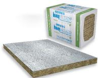
Knauf Thermo-teK BD 60 AluR mit ca. 60 kg/m<sup>3</sup> ist eine Mineralwolle-Dämmplatte mit formaldehydfreiem Bindemittel und einseitiger Alu-Kaschierung. Das Produkt wird zum Wärme-, Schall- und Brandschutz im gesamten Bereich der technischen Isolierung eingesetzt.
