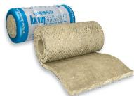
Drahtnetzmatten mit ca. 80 kg/m<sup>3</sup> sind mit verzinktem Draht auf Drahtnetz (20 mm x 0.7 mm) gesteppte Steinwollmatten für Industrie und Schiffbau.
