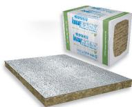
Das Knauf Insulation BD 908 ALU (HBD F08 ALUR) Fire-teK System dient dem vorbeugenden Brandschutz an Lüftungsanälen. Es kommen Mineralwolle-Platten zum Einsatz, die einseitig mit einer reissfesten, glasgitterverstärkten Aluminium-Folie versehen sind. Das Knauf Insulation Fire-teK System schützt nicht nur im Brandfall, sondern verfügt gleichzeitig über gute Wärme- und Schallschutzeigenschaften. Die maximale Abmessung des Lüftungsanälenquerschnittes beträgt 1'250 x 1'000 mm.
