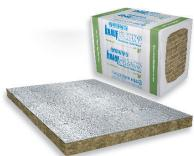
Knauf Thermo-teK BD 45 AluR mit ca. 45 kg/m<sup>3</sup> ist eine Mineralwolle-Dämmplatte mit formaldehydfreiem Bindemittel und einseitiger Alu-Kaschierung. Das Produkt wird zum Wärme-, Schall- und Brandschutz im gesamten Bereich der technischen Isolierung eingesetzt.
