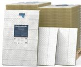
Multimastic SP ist eine Brandschutzfugenmasse auf Acrylbasis für die Brandabschottung von Öffnungen rund um Kabeltrassen, Rohr- und Kabeldurchführungen und für das (untereinander) Verleimen von Brandschutzplatten Multimastic FB1/FB2. Multimastic SP dehnt sich aus, wenn es Hitze ausgesetzt wird, und sorgt für eine feuerfeste und rauchdichte Abschottung zu angrenzenden Räumen.
