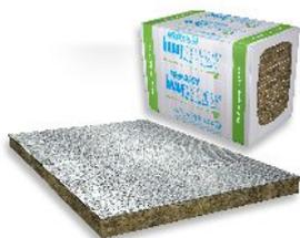
Das Knauf Insulation BD 912 ALU (HBD F12 ALUR) Fire-teK System dient dem vorbeugenden Brandschutz an Lüftungskanälen. Es kommen Mineralwolle-Platten zum Einsatz, die einseitig mit einer reissfesten, glasgitterverstärkten Aluminium-Folie versehen sind. Das Knauf Insulation Fire-teK System schützt nicht nur im Brandfall, sondern verfügt gleichzeitig über gute Wärme- und Schallschutzeigenschaften. Die maximale Abmessung des Lüftungskanalquerschnittes beträgt 1'250 x 1'000 mm.
