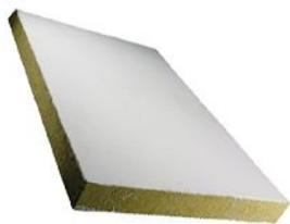
Mineralfaserplatten gemäss EN 13162 mit Klassifizierung A1 gemäss EN 13501-1 mit einer Dicke von 60 mm. Sie weisen eine Mindestrohdichte von 150 kg/m<sup>3</sup> und einen Schmelzpunkt von 1000 °C. Die Mineralfaserplatten können bei uns ab Lager vorbeschichtet oder ohne Beschichtung per Stück oder per Palette bezogen werden. Nach dem Einbau müssen die Platten mit der zum ausgewählten System gehörenden Farbe noch einmal überstrichen werden.
