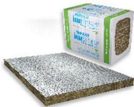
Das Knauf Insulation BD 908 ALU (HBD F08 ALUR) Fire-teK System dient dem vorbeugenden Brandschutz an Lüftungskanälen. Es kommen Mineralwolle-Platten zum Einsatz, die einseitig mit einer reissfesten, glasgitterverstärkten Aluminium-Folie versehen sind. Das Knauf Insulation Fire-teK System schützt nicht nur im Brandfall, sondern verfügt gleichzeitig über gute Wärme- und Schallschutzeigenschaften. Die maximale Abmessung des Lüftungskanalquerschnittes beträgt 1'250 x 1'000 mm.
