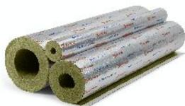
Die Conlit Steelprotect Section ist eine nichtbrennbare druckfeste Steinwolle-Brandschutzschale, die vorzugsweise für Brandschutzanwendungen an runden Bauteilen verwendet wird. Mit gitternetzverstärkter Aluminiumfolie, einseitig aufgeschlitzt zur leichteren Montage auf der Innenwandung eingesägt.
