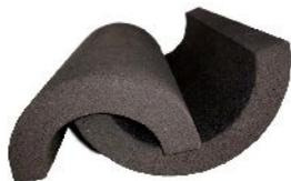
FOAMGLAS® Isolierschalen werden aus hochwertigem Recycling-Glas (>66 %) und aus natürlichen, nahezu unbegrenzt vorkommenden Rohstoffen (Sand, Dolomit, Kalk) hergestellt. Der Dämmstoff enthält keine ozonschädigenden Treibgase (FCKW/H-FCKW usw.), Flammenschutzmittel oder Bindemittel.
