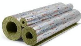
Nicht brennbare, kunstharzgebundene, druckfeste Steinwolle-Brandschutzschale für den Einsatz von Rohrabschottungen. Die Conlit® 150 U Brandschutzschale ist mit einer farbig gekennzeichneter gitternetzverstärkter Aluminium-Sandwich-Folie kaschiert. Die Brandschutzschale Conlit® 150 U ist einseitig aufgeschlitzt und auf der Innenwandung eingesägt, damit sie leicht aufgeklappt auf der Rohrleitung montiert werden kann.
