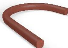
Fire-teK® INT ist ein komprimierbares Fugenband auf Polyurethanbasis und dient als intumeszierende Brandschutzfugendichtung bei Wand-/Deckendurchdringungen. Es wird in einer Länge von 1 Meter verkauft und hat eine rotbraune Farbe.
