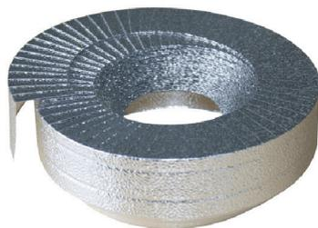
Manschettenbreite 35 mm, rechtwinklig abgebogen und mit 7 - 11 mm breiten Lamellen ausgerüstet. Lamellenlänge und breite der Dämmstärke entsprechend. Grobkorn-Endmanschette mit 2 Sicken für Bindedraht.
