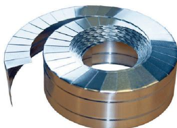
Manschettenbreite 35 mm, rechtwinklig abgebogen und mit 7 - 11 mm breiten Lamellen ausgerüstet. Lamellenlänge und breite der Dämmstärke entsprechend. Alu-Endmanschette mit 2 Sicken für Bindedraht.
