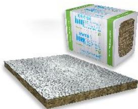
Knauf Thermo-teK BD 45 AluR mit ca. 45 kg/m<sup>3</sup> ist eine Mineralwolle-Dämmplatte mit formaldehydfreiem Bindemittel und einseitiger Alu-Kaschierung. Das Produkt wird zum Wärme-, Schall- und Brandschutz im gesamten Bereich der technischen Isolierung eingesetzt.
