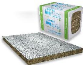
Knauf Thermo-teK BD 80 AluR mit ca. 80 kg/m<sup>3</sup> ist eine Mineralwolle-Dämmplatte mit formaldehydfreiem Bindemittel und einseitiger Alu-Kaschierung. Das Produkt wird zum Wärme-, Schall- und Brandschutz im gesamten Bereich der technischen Isolierung eingesetzt.
