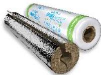
Die Steinwolle-Rohrschalen Thermo-teK PS PRO ALU bisher: HPS 035 AluR sind gewickelte und geschliffene Rohrschalen aus Steinwolle. Das Produkt ist mit einer glasfaserverstärkten Aluminiumkaschierung ummantelt und ist längsseitig mit einem Selbstklebeverschluss ausgerüstet.
