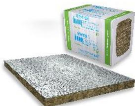
Knauf Thermo-teK BD 60 AluR mit ca. 60 kg/m<sup>3</sup> ist eine Mineralwolle-Dämmplatte mit formaldehydfreiem Bindemittel und einseitiger Alu-Kaschierung. Das Produkt wird zum Wärme-, Schall- und Brandschutz im gesamten Bereich der technischen Isolierung eingesetzt.
